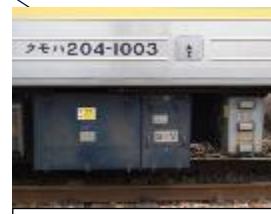
補助電源は種車が補助電源無の車だったため新設、電動発電機(MG)が製造終了していたためSIVを採用。5000番台、JR西1000番台、中間改造車のみの特徴だ。
