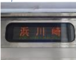
(行き先表示機) 3色LED式を採用、鶴見線向け 1100-0番台と収録内容は共通、前 面表示器は少し右側に寄っている
