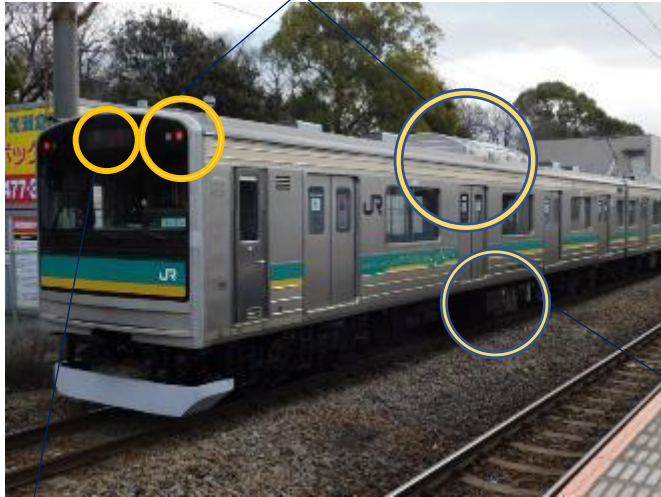
(行き先表示機) 3色LED式を採用、鶴見線向け 1100-0番台と収録内容は共通、前 面表示器は少し右側に寄っている
