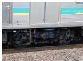
国鉄初のボルスタレス台車であるDT50D モーターはMT61を採用しMc205-1003 のみ冷却ファンが内側の内扇モーター、 その他が冷却ファンが外側の外扇モータ
